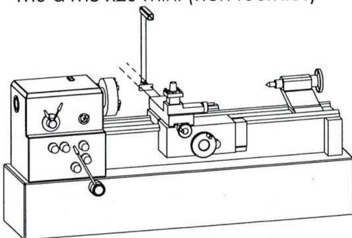
3- Monter et régler l'écran sur la potence, bloquer la position à l'aide de vis moulées M8 x10
